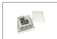
B71/PBX36/BOX/115 Falownik hybrydowy w wersji „Network Assisted” do zasilania automatyki, z funkcj adowania akumulatorów poprzez podczenie do paneli sonecznych lub staej sieci w celu zasilania sterowników cyfrowych silników bezszczotkowych napiciem 36V DC przy napiciu sieciowym 115V AC.
